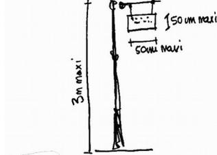
Pour les commerces non situés à l'alignement, l'enseigne drapeau pourra être fixée sur un poteau en métal ou en bois de 3m de haut maxi. Le poteau sera placé sur le terrain du commerce au niveau du portail ou du portillon d'entrée.
